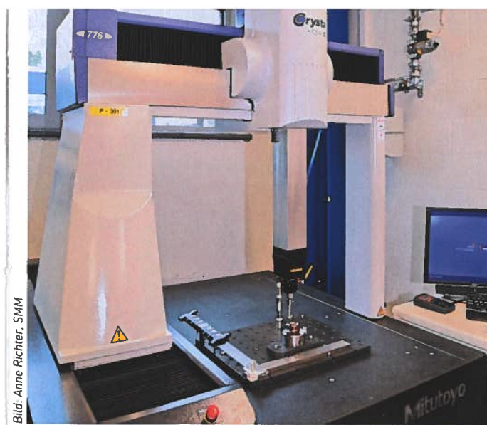
Qualitätssicherung: Bauteilvermessung an Koordinatenmessmaschine.
