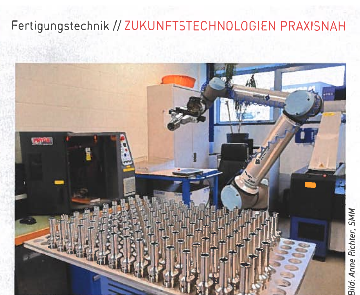
Automatisierte Laserbeschriftung der Bauteile.
